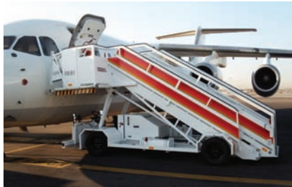
SELF PROPELLED PASSENGER STEP, MODEL EDA-18425 Equipos Industriales De Manutencion S.A. (EINSA)
